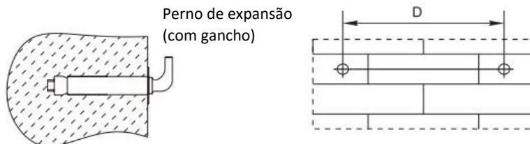
3. Instale a tomada de alimentação na parede. A tomada de alimentação deve ser de 3 pinos, monofásica, 230V/16A. Recomenda-se colocar a tomada à direita acima do aquecedor. A altura da tomada em relação ao solo não deve ser inferior a 1,8 m.
