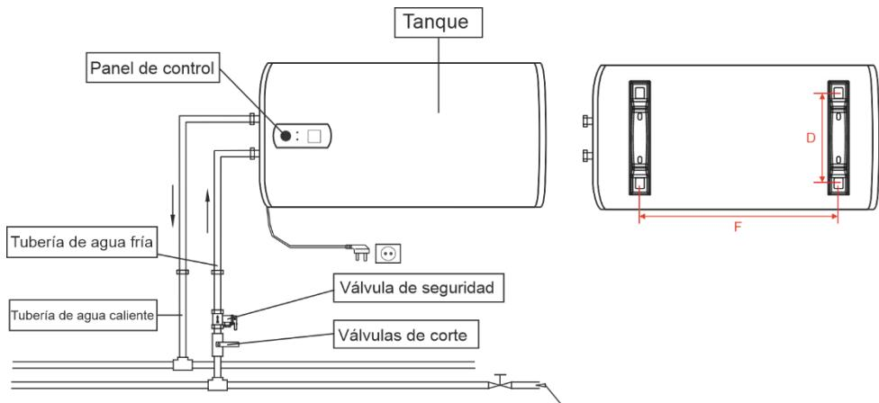
3. Instale la toma de corriente en la pared. La toma de alimentación debe ser de 3 pines, monofásica, 230V/16A. Se recomienda colocar el enchufe a la derecha encima del calentador. La altura del zócalo al suelo no debe ser inferior a 1,8 m.
