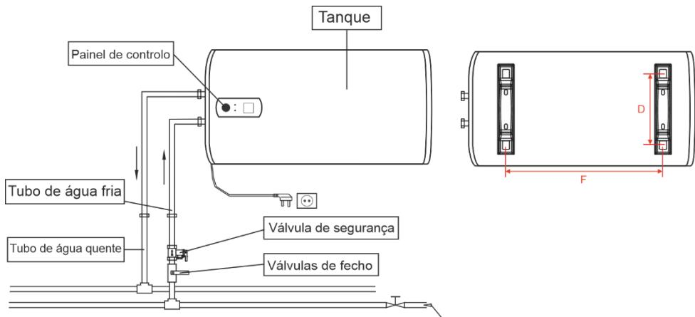
3. Instale a tomada de alimentação na parede. A tomada de alimentação deve ser de 3 pinos, monofásica, 230V/16A. Recomenda-se colocar a tomada à direita acima do aquecedor. A altura da tomada em relação ao solo não deve ser inferior a 1,8 m.
