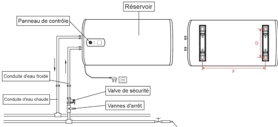
3. Installez la prise d'alimentation dans le mur. La prise d'alimentation doit être à 3 broches, monophasée, 230V / 16A. Il est recommandé de placer la prise à droite au-dessus du radiateur. La hauteur de la prise au sol ne doit pas être inférieure à 1,8 m.
